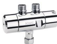
Sicherheitsthermostatischer Vormischer – Anschlussgewinde ¾" – Montage auf Eckventil – Separat bestellen (optional oder falls erforderlich): – Anschluss-Set 12.000.610.000
